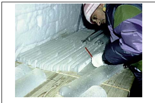
Figure 3.4 : carotte de glace effectuée en Antarctique (© CNRS, Photo : R. Delmas)
